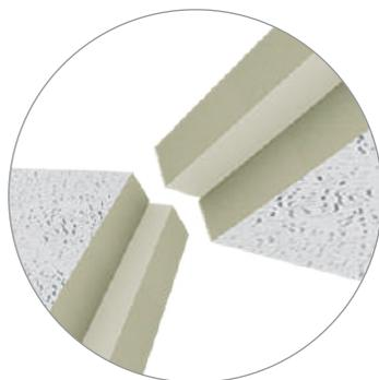
*Îmbinarea tip „L” minimizează punțile termice, asigurând o izolare continuă la joncțiunea dintre plăci.*
